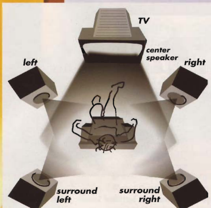
De ideale opstelling van het Surround Sound-systeem. Om een optimaal effect te bereiken, moeten de twee rear luidsprekers achter de kijker geplaatst worden.
