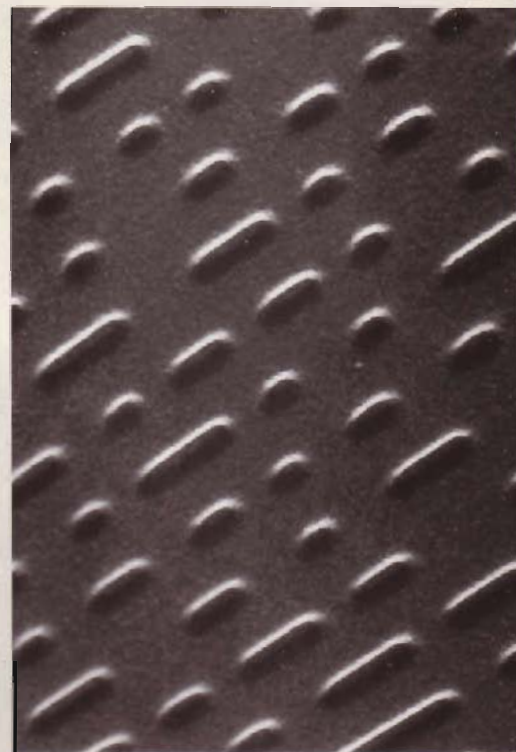
Sporen op een Compact-Disc (sterk vergroot)
